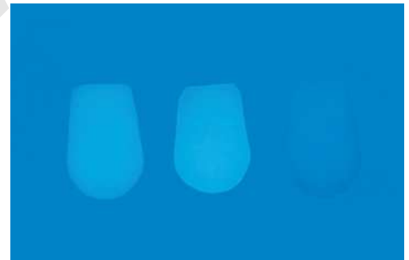
Abb. 10a: Fluoreszenz unterschiedlicher Keramiken: Creation Press, Authentic und IPS e.max LT (v. l.).
