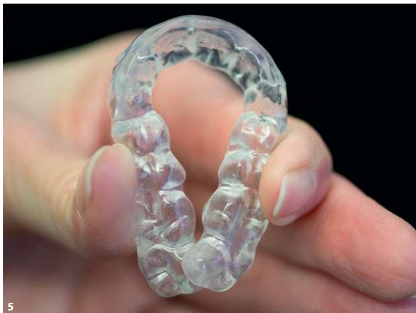
Abb. 4 Das verwendete Druckmaterial mit den Schienen vor der Ablösung von der Druckplattform. Abb. 5 Die fertig gedruckte und polierte Schiene im Biegetest (siehe Video).
