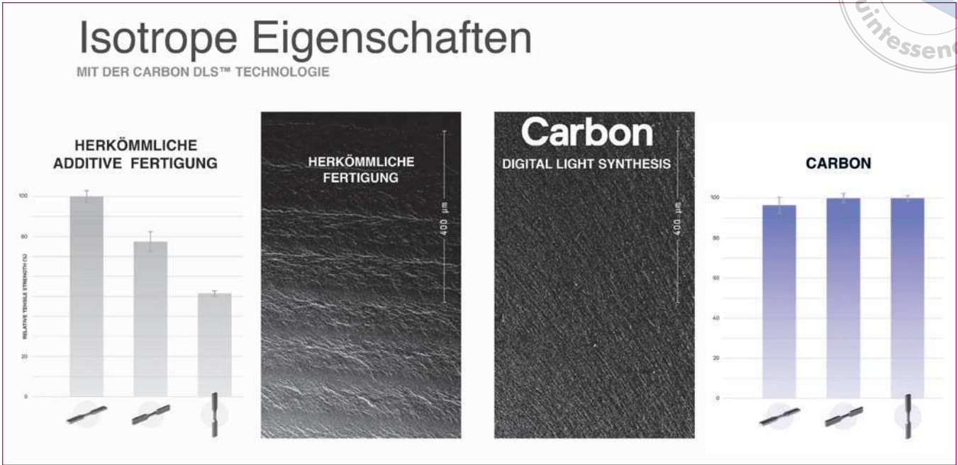
Abb. 1 Darstellung der isotropen Materialeigenschaften durch das DLS-Verfahren im Schnittbild (Abbildung Fa. Carbon3D Inc.).
