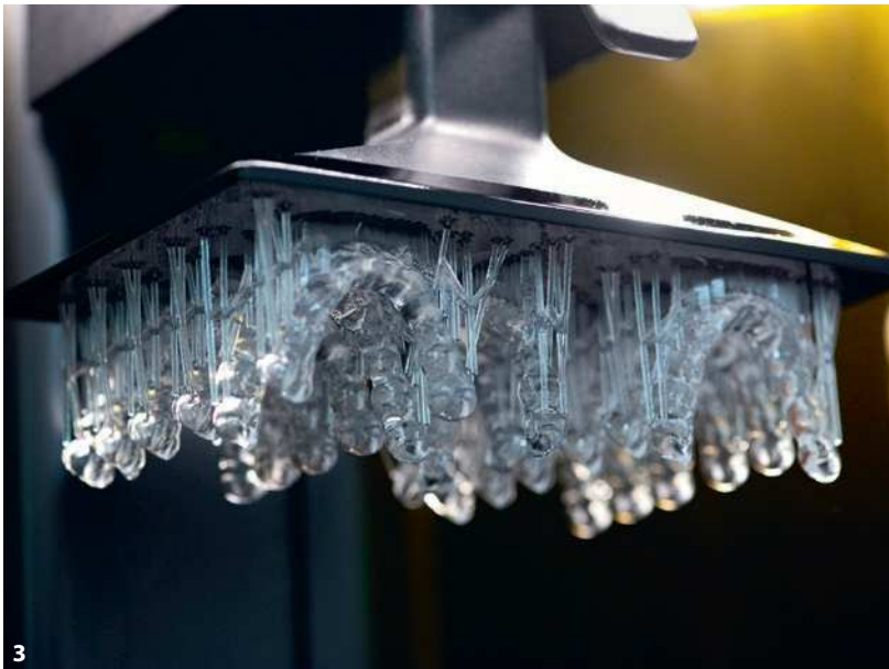
Abb. 2 Die Aufbissschienen im Druckprozess. Abb. 3 Die fertig gedruckten Schienen im Drucker.
