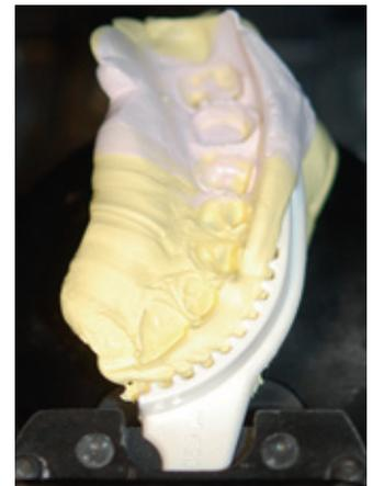
Abb. 4 Einrichtvorrichtung für einen Abformlöffel im Laborscanner.
